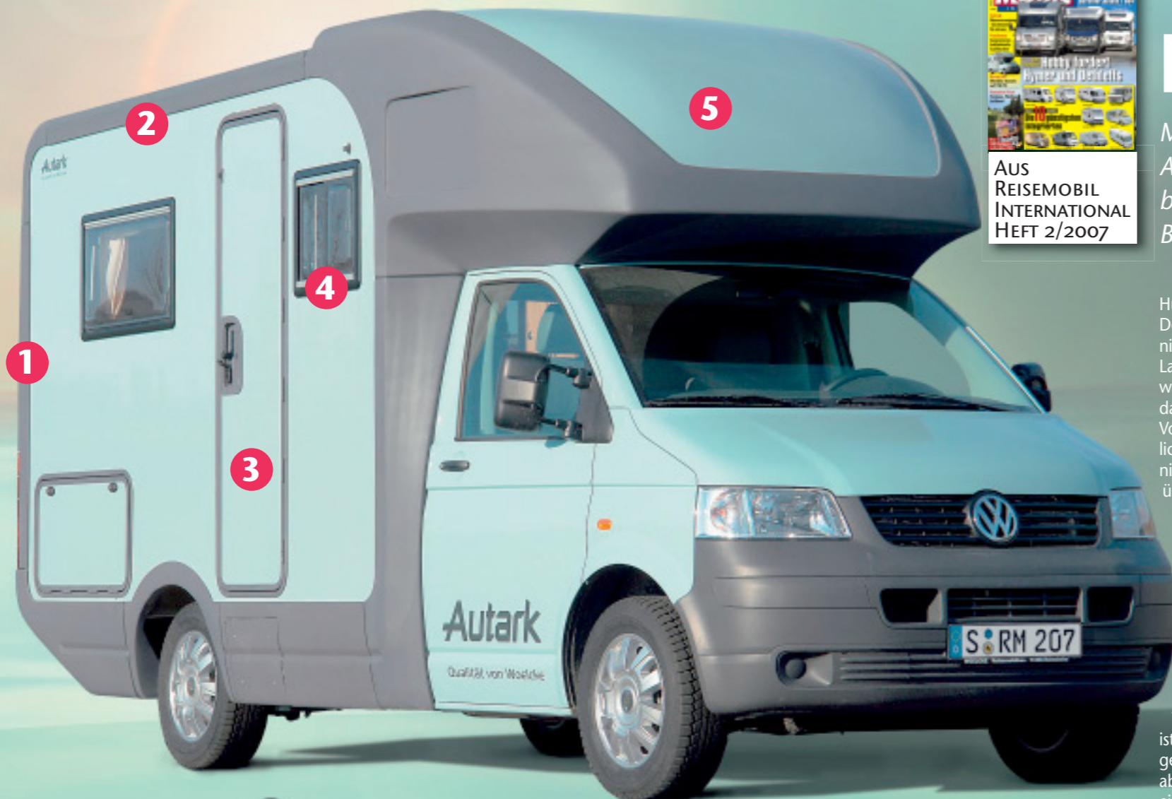
Tresor: Etwas unhandlich in der Bedienung ist die enorm robuste Woelcke-Tür mit Dreifachsicherung. Sie bietet hohen Schutz gegen Einbruch. Zudem lässt sich ein gleichschließendes Schloss einbauen, in das dann auch der Haustürschlüssel passt. Sehr praktisch.
