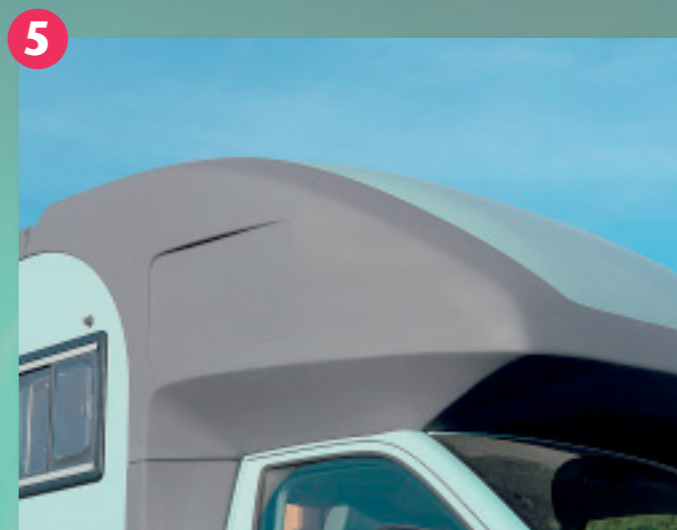
Kappe auf: Im Autark-Dach vereinigt Woelcke das Platzangebot eines Alkovens mit der Windschnittigkeit eines Teilintegrierten. An der Seite sind die Aussparungen für ein Fenster zu sehen. Zwei Kinder oder ein Erwachsener finden im „Alkoven“ genügend Platz zum Schlafen.
